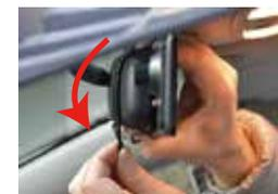
②ルームミラーを挟み込むようにして、本体のクリップ部に取付バンドを付ける。
