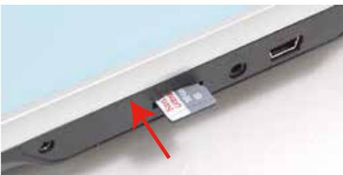
カードを抜く時は、カードを爪先で押し込むと、カードが出てきますので、挿んで抜いて下さい。
